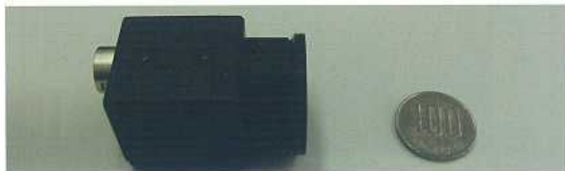
写真1 世界最小200万画素のCCDカメラ
