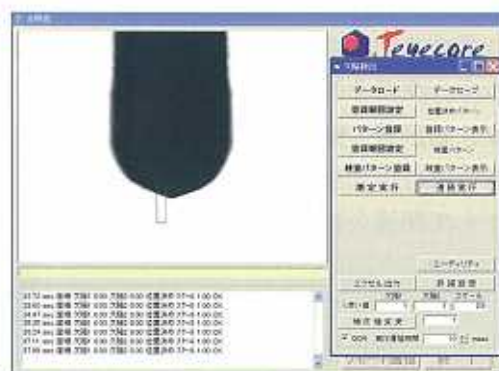
図3 工具の欠損、摩耗測定
