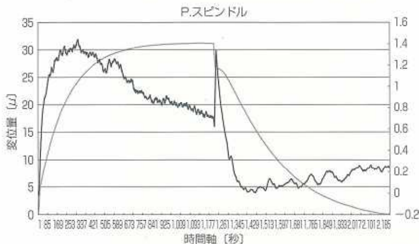
主軸の変位を連続的に測定。伸びのサチュレートを確認した後、1,100秒付近で停止。その後、伸びがゼロに戻るまでを計測。緩やかに上がっている曲線が伸び量(Z軸)。もう一方がY方向のシフト量。伸びはグラフ左側の目盛りで参照、シフトは右側の目盛りで参照。
