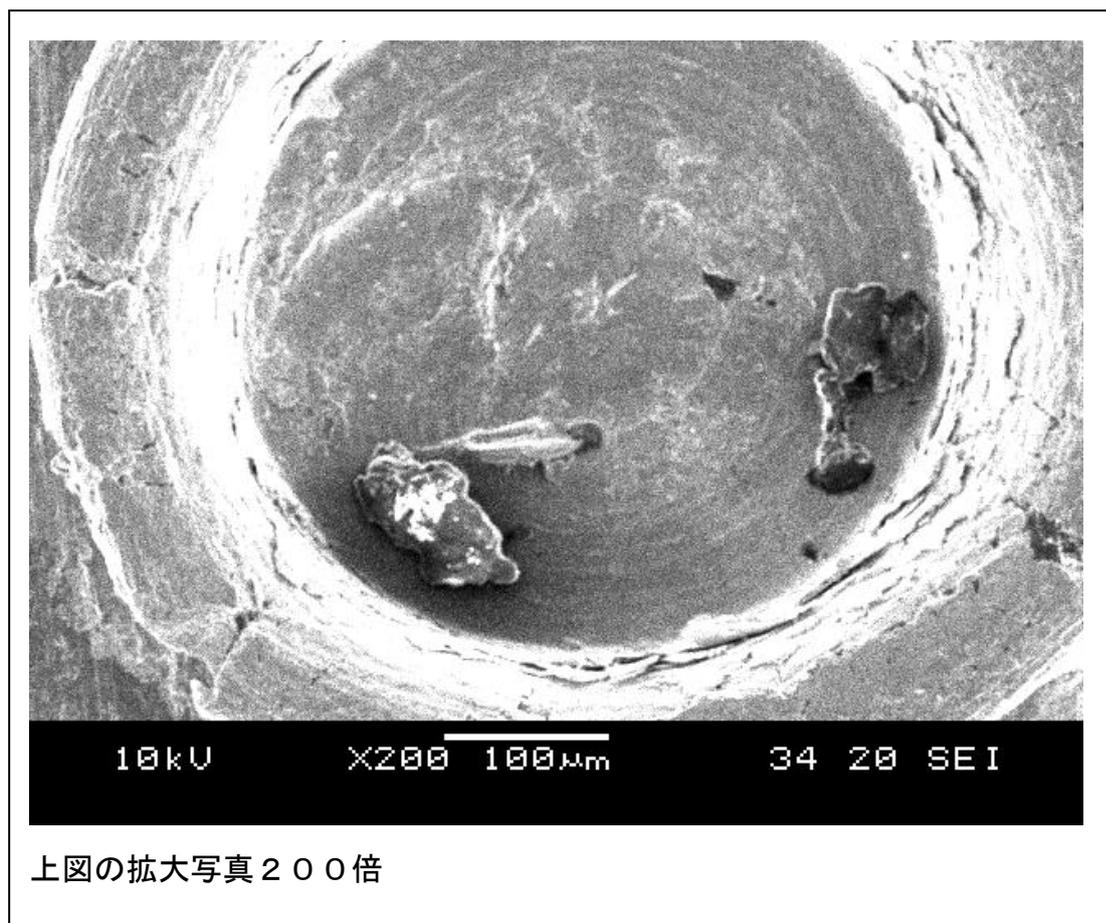
振れの無いドリルで仕上げたワークの穴径は $320\mu\text{m}$ に対して、振れの有る物の径は $420\sim 466.6\mu\text{m}$ となっている。
