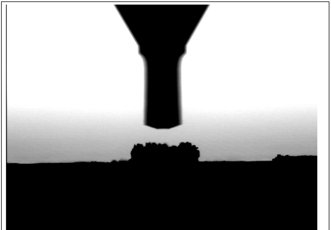
写真でも分かるように振れ回りで本来は、先端の三角錐の部分が平らに見える。
