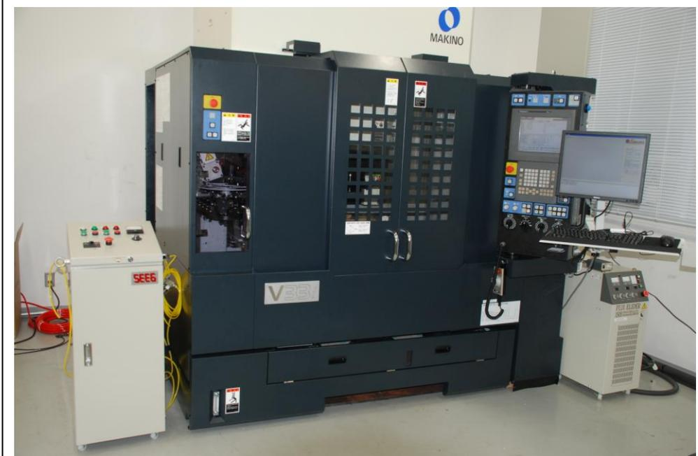
マキノ V33i 主要諸元 主軸回転 : 30,000rpm 移動量 (X/Y/Z) : 650×450×350mm
